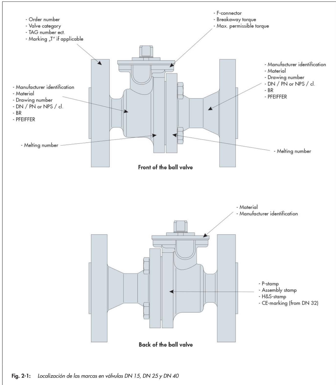
**Tabla 2-2:** Localización y tipo de marcado en las válvulas DN 15, DN 25 y DN 40
