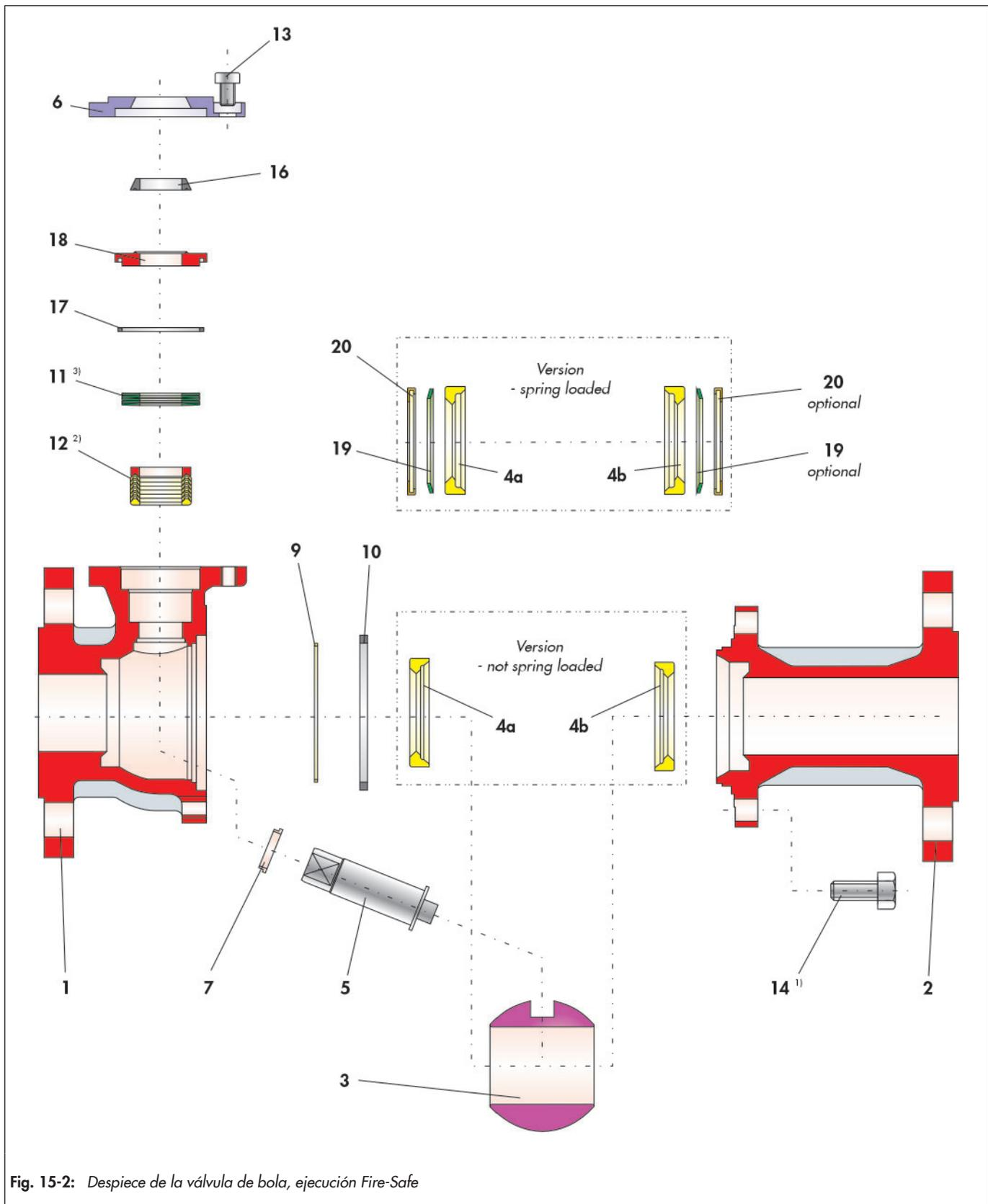
Fig. 15-2: Despiece de la válvula de bola, ejecución Fire-Safe
