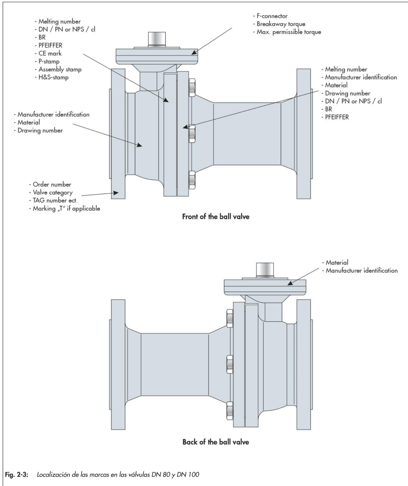
Fig. 2-3: Localización de las marcas en las válvulas DN 80 y DN 100
