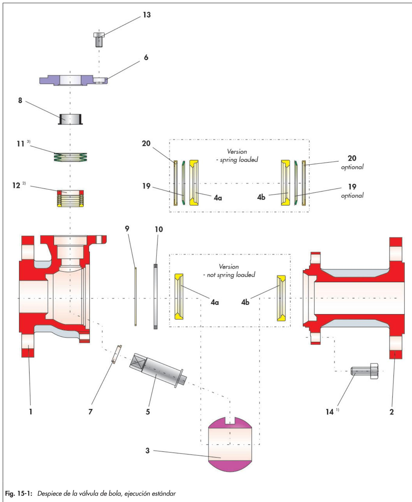
Fig. 15-1: Despiece de la válvula de bola, ejecución estándar
