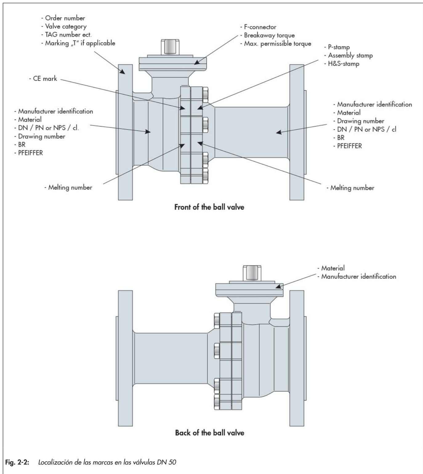
Fig. 2-2: Localización de las marcas en las válvulas DN 50
