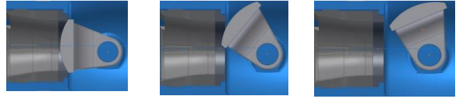
Bild 10: Kegelbewegung bei doppel-exzentrischer Lagerung
