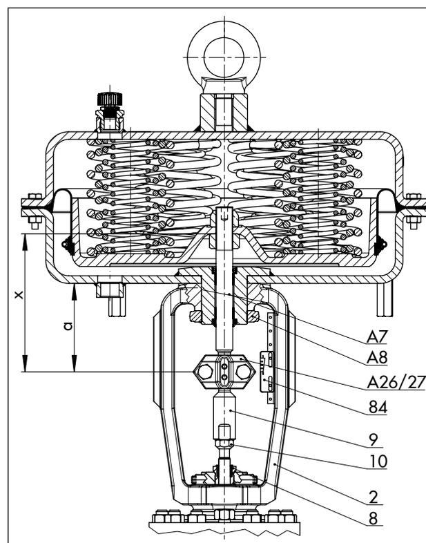
**Рис. 8:** Пневматический привод Тип 3271, смонтированный на прямоходном клапане
