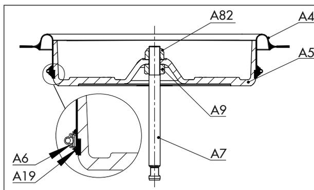
**Рис. 13:** Расположение компонентов для рабочего направления «Шток привода выдвигается FA» (1400-60 см<sup>2</sup>)
