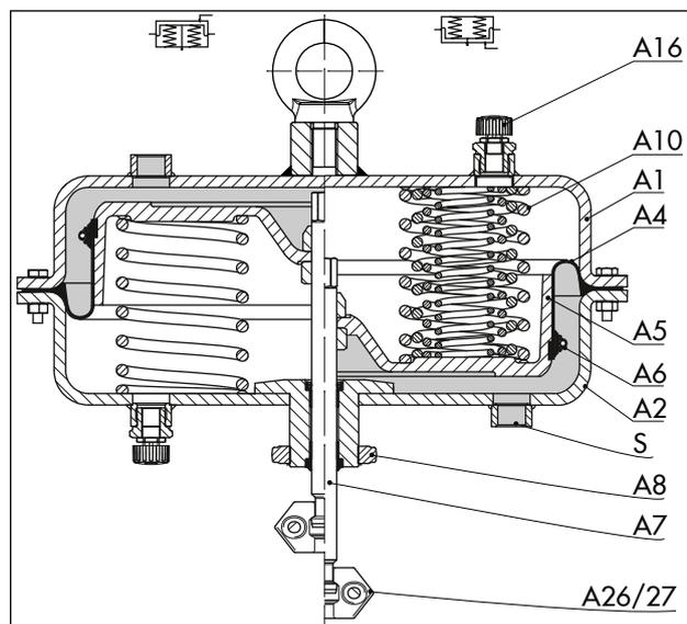
**Рис. 12:** Пневматический привод Тип 3271 (примерное изображение) с площадью 1400-60 см<sup>2</sup>
