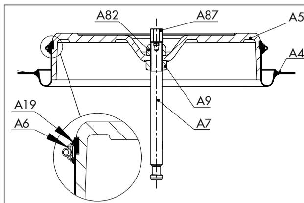
**Рис. 15:** Расположение компонентов для рабочего направления «Шток привода тягивается FE» (1400-60 см<sup>2</sup>)
