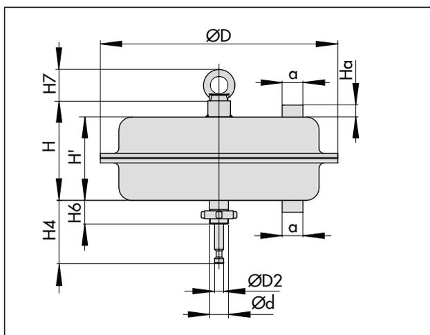
Рис. 3: Тип 3271 с площадью привода 1400-60 см<sup>2</sup>
