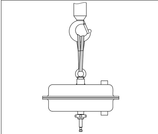
Рис. 6: Точка подъема на приводе
