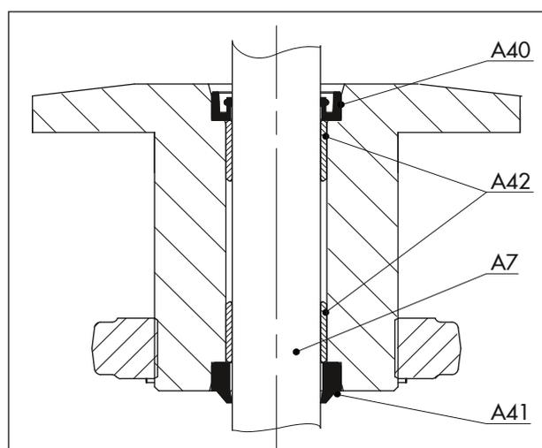
**Рис. 17:** Уплотнение штока привода Тип 3271
