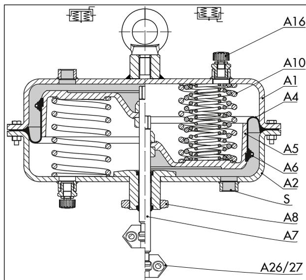
Рис. 2: Пневматический привод Тип 3271 (примерное изображение) с площадью 1400-60  $\text{см}^2$
