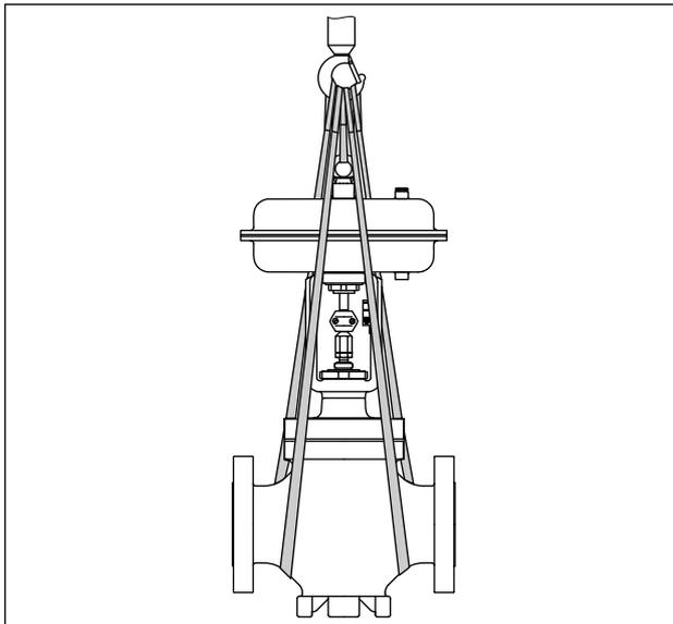
Рис. 7: Точки подъема на регулирующем клапане (пример)
