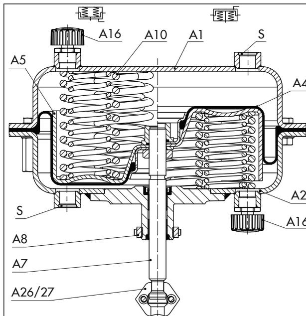
Рис. 2: Привод Тип 3271 (примерное изображение) с площадью 355v2 см<sup>2</sup>
