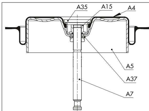
**Рис. 18:** Расположение деталей для рабочего направления «Шток привода втягивается FE»
