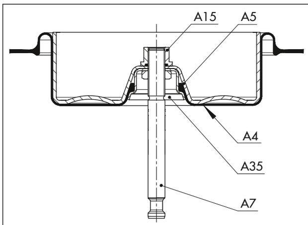
**Рис. 19:** Расположение компонентов для рабочего направления «Шток привода выдвигается FA»
