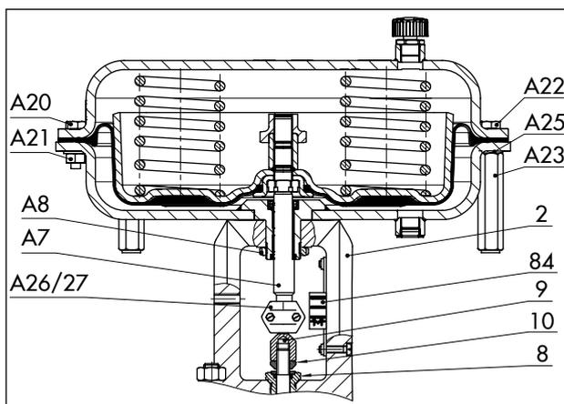
**Рис. 12:** Пневматический привод Тип 3271, смонтированный на прямоходном клапане
