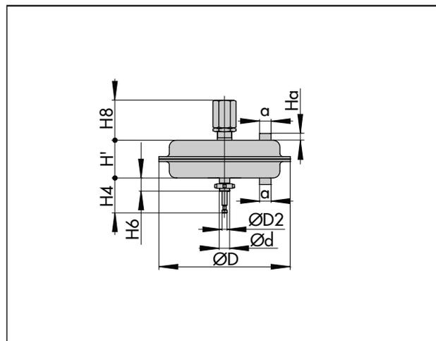
Рис. 6: Тип 3271 с ограничителем хода
