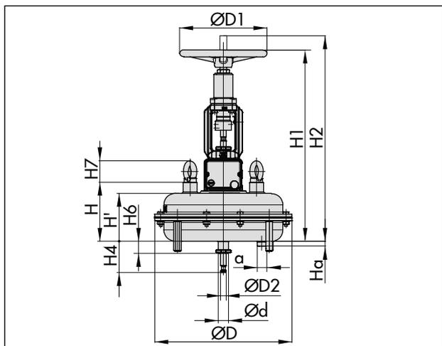
Рис. 5: Тип 3271 с ограничителем хода с обеих сторон и ручным дублёром
