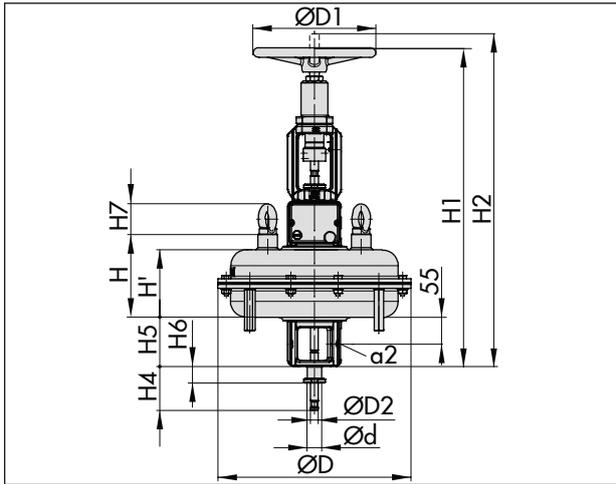
Рис. 8: Тип 3277 с ограничителем хода с обеих сторон и ручным дублёром
