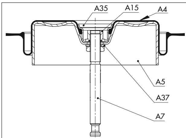
**Рис. 16:** Расположение деталей для рабочего направления «Шток привода вытягивается FE»
