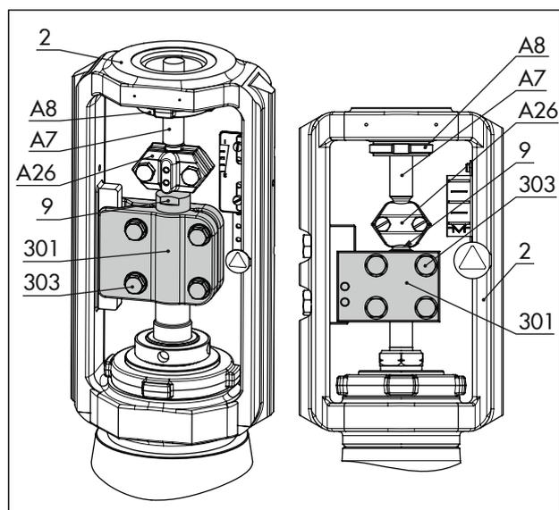
**Рис. 11:** Защита от проворачивания: стандартная версия на рисунке слева, специальная версия на рисунке справа
