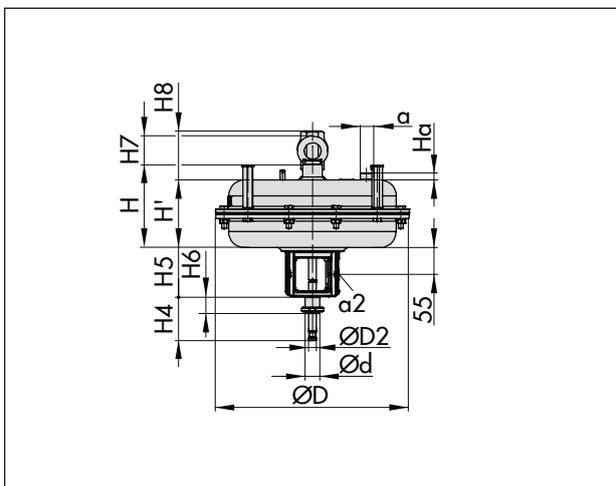
Рис. 9: Тип 3277 с ограничителем хода
