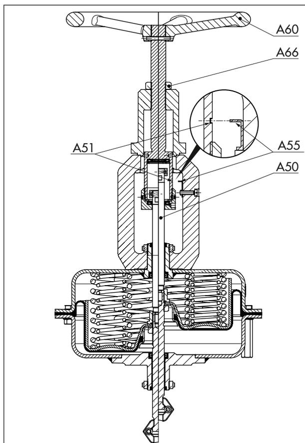
Рис. 14: Привод Тип 3271 с ручным дублёром (355v2 см<sup>2</sup>)
