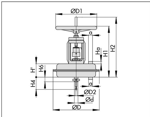
Рис. 4: Тип 3271 с дополнительным ручным дублёром
