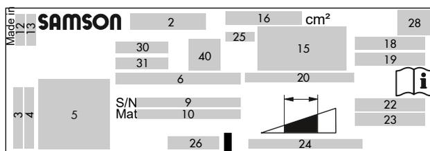
**Рис. 1:** Информация на типовом шильдике на приводе Тип 3271/3277 для всех площадей приводов > 120 см<sup>2</sup> или Тип 3372 с площадью привода 350 см<sup>2</sup>
