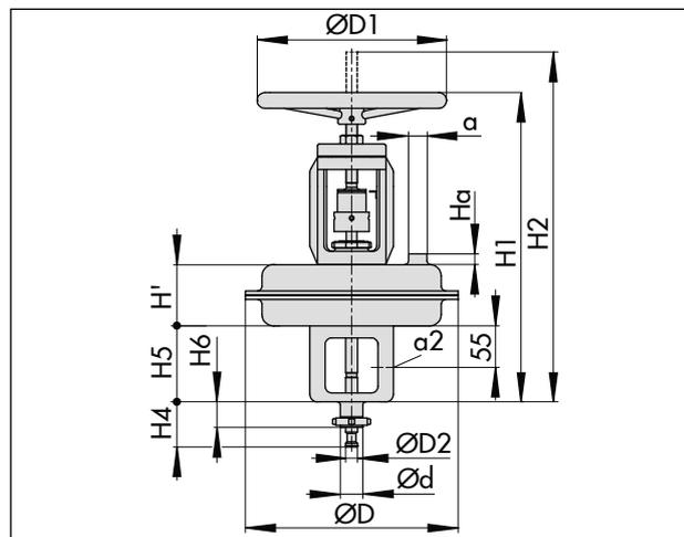
Рис. 7: Тип 3277 с дополнительным ручным дублёром
