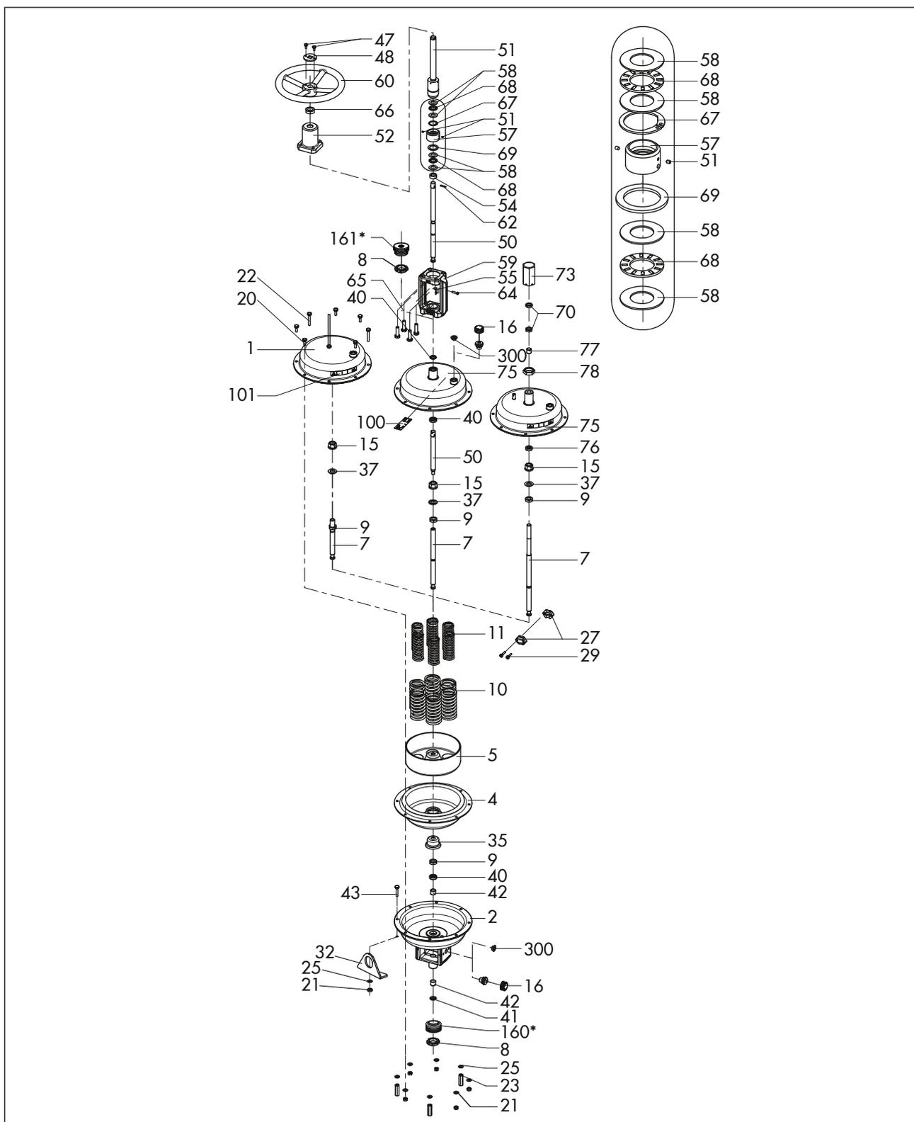
Рис. 22: Привод Тип 3277, 355v2 см²
