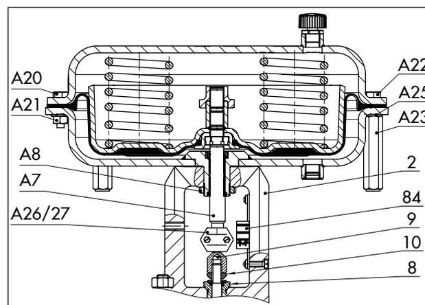
**Рис. 10:** Пневматический привод Тип 3271, смонтированный на прямоходном клапане
