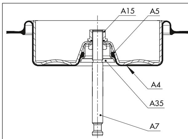
**Рис. 15:** Расположение компонентов для рабочего направления «Шток привода выдвигается FA»
