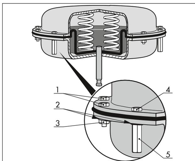
**Рис. 20:** Предварительно напряжённые пружины (принципиальная схема)
