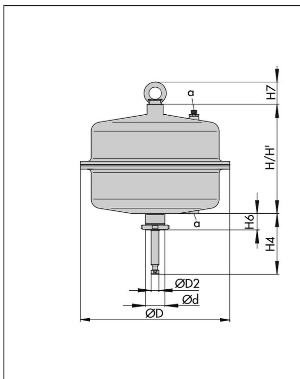
Рис. 5: Тип 3271 с площадью привода 2800 см<sup>2</sup>
