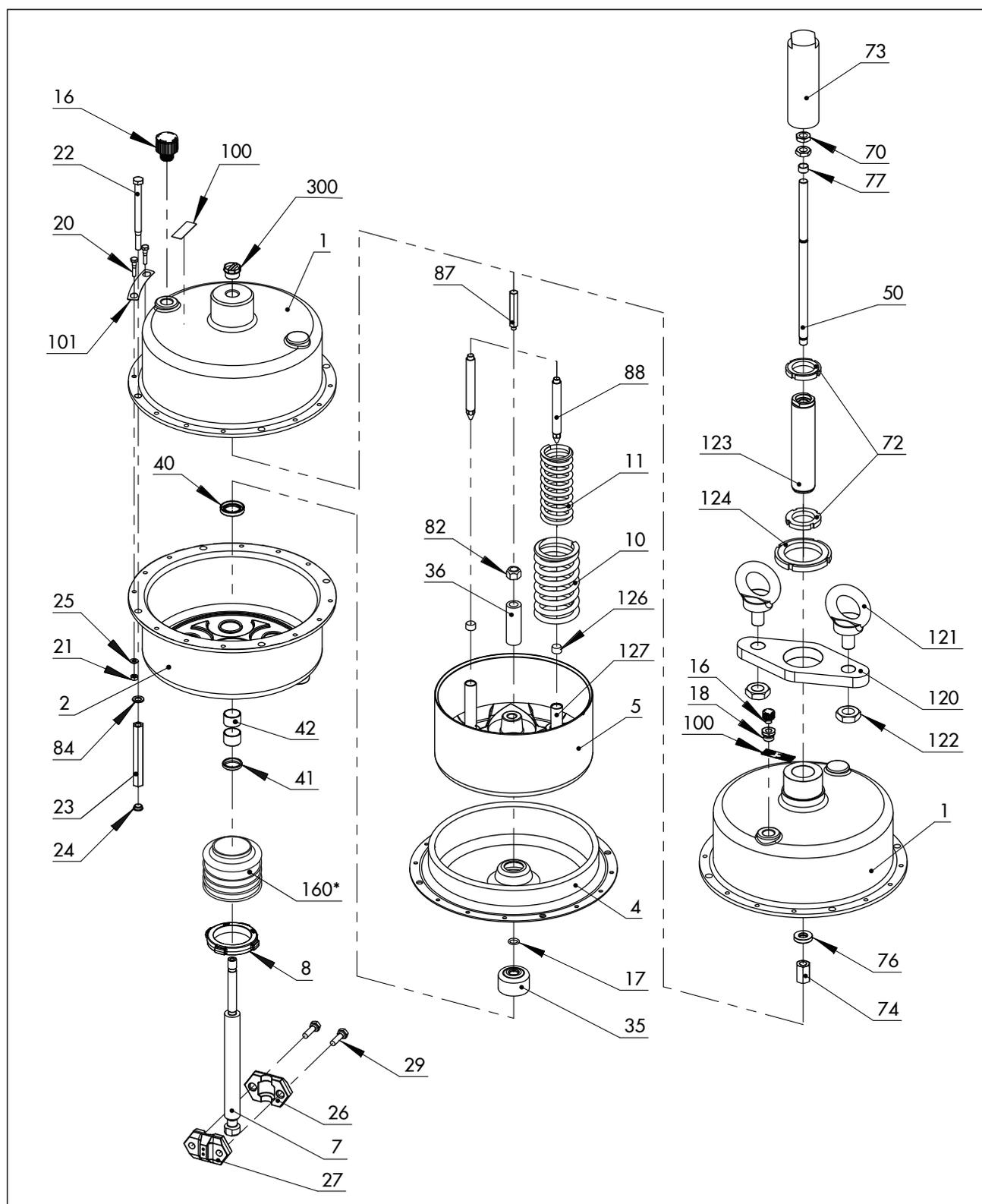
Рис. 17: Привод Тип 3271, 1400-120 см²
