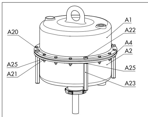
**Рис. 12:** Привод с зажимными винтами и зажимными гайками
