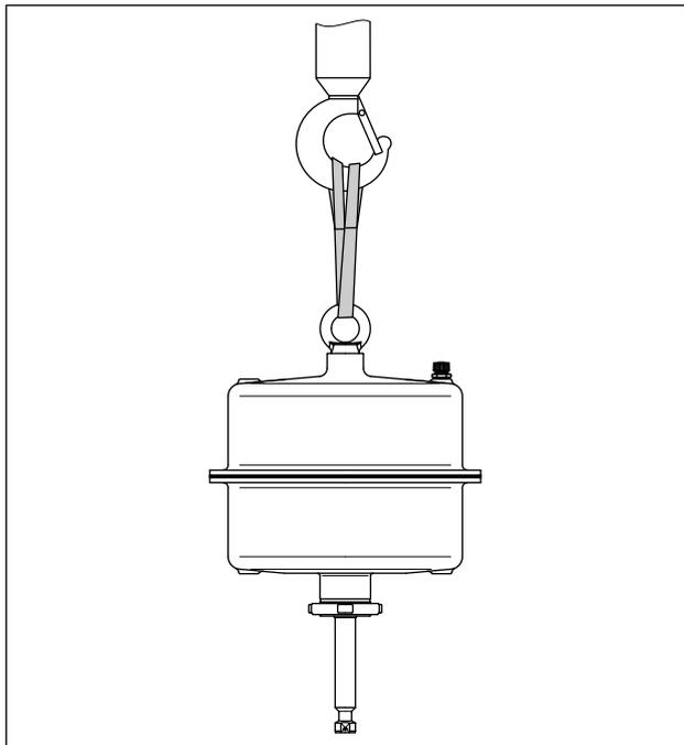
Рис. 8: Точка подъема на приводе
