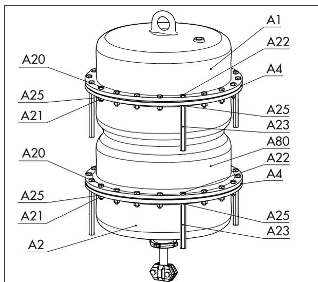
**Рис. 13:** Тандемный привод с зажимными винтами и зажимными гайками
