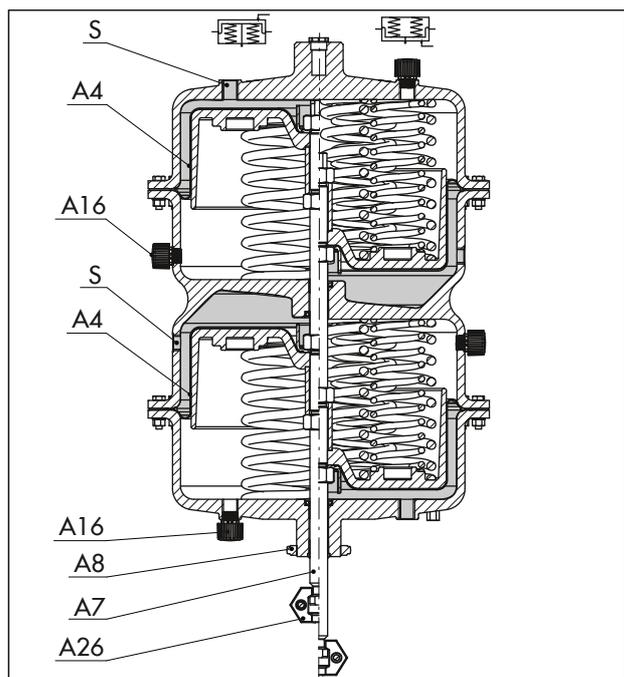
**Рис. 3:** Пневматический привод Тип 3271 (примерное изображение) с площадью  $2 \times 2800 \text{ см}^2$
