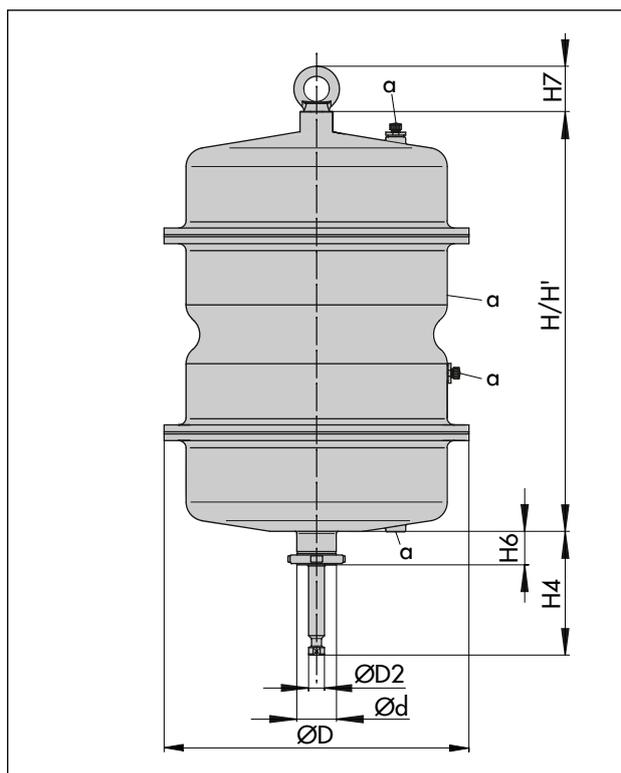
Рис. 6: Сдвоенный привод Тип 3271
