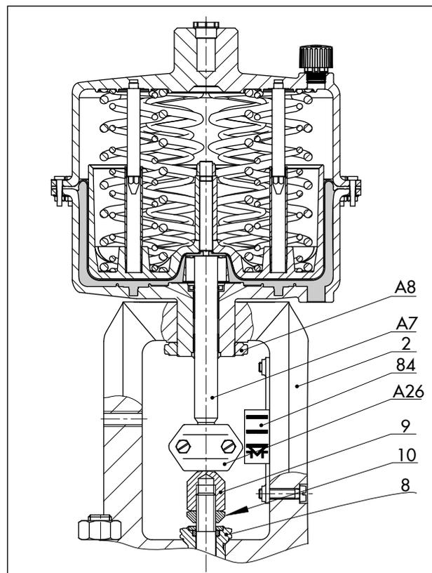
**Рис. 10:** Пневматический привод Тип 3271, смонтированный на прямоходном клапане
