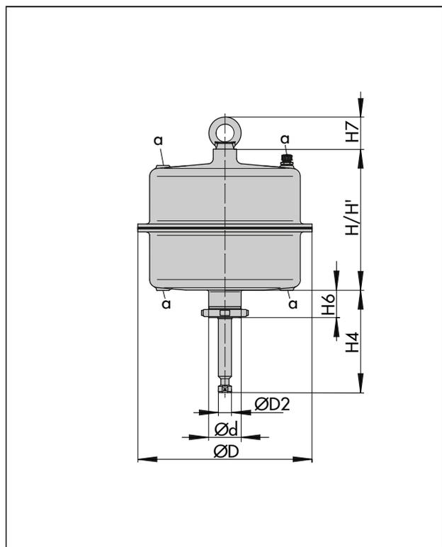
Рис. 4: Тип 3271 с площадью привода 1400-120 см<sup>2</sup>
