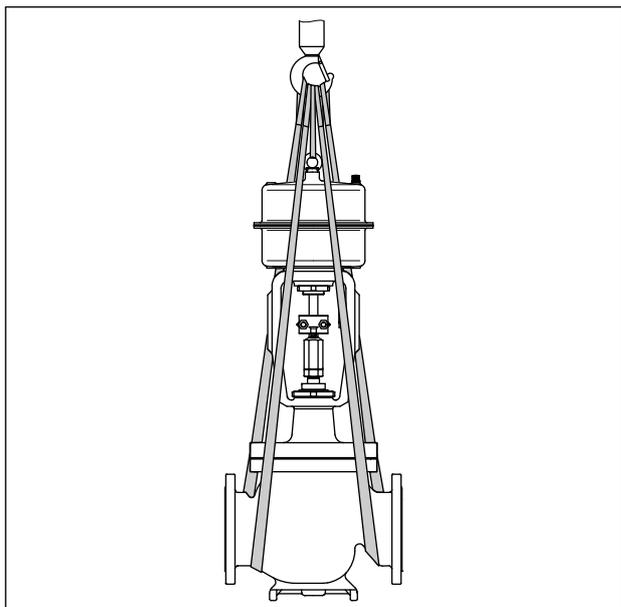
Рис. 9: Точки подъёма на регулирующем клапане (пример)
