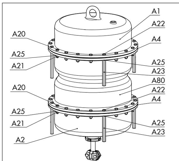
**Рис. 16:** Тандемный привод с зажимными винтами и зажимными гайками
