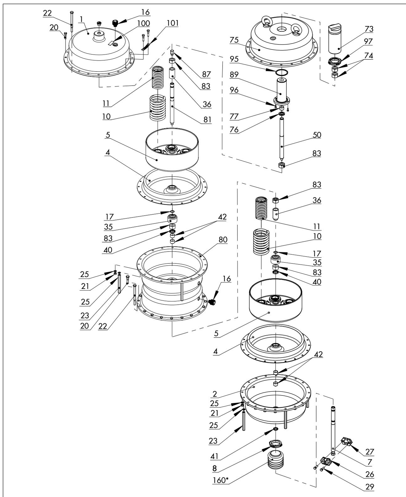
Рис. 19: Привод Тип 3271, 2x 2800 см<sup>2</sup>
