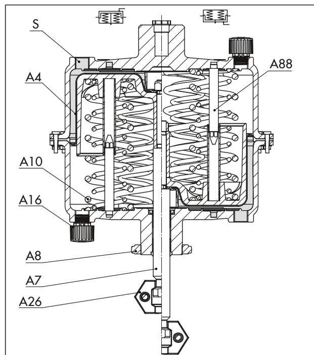
**Рис. 2:** Пневматический привод Тип 3271 (примерное изображение) с площадью  $1400-120 \text{ см}^2$
