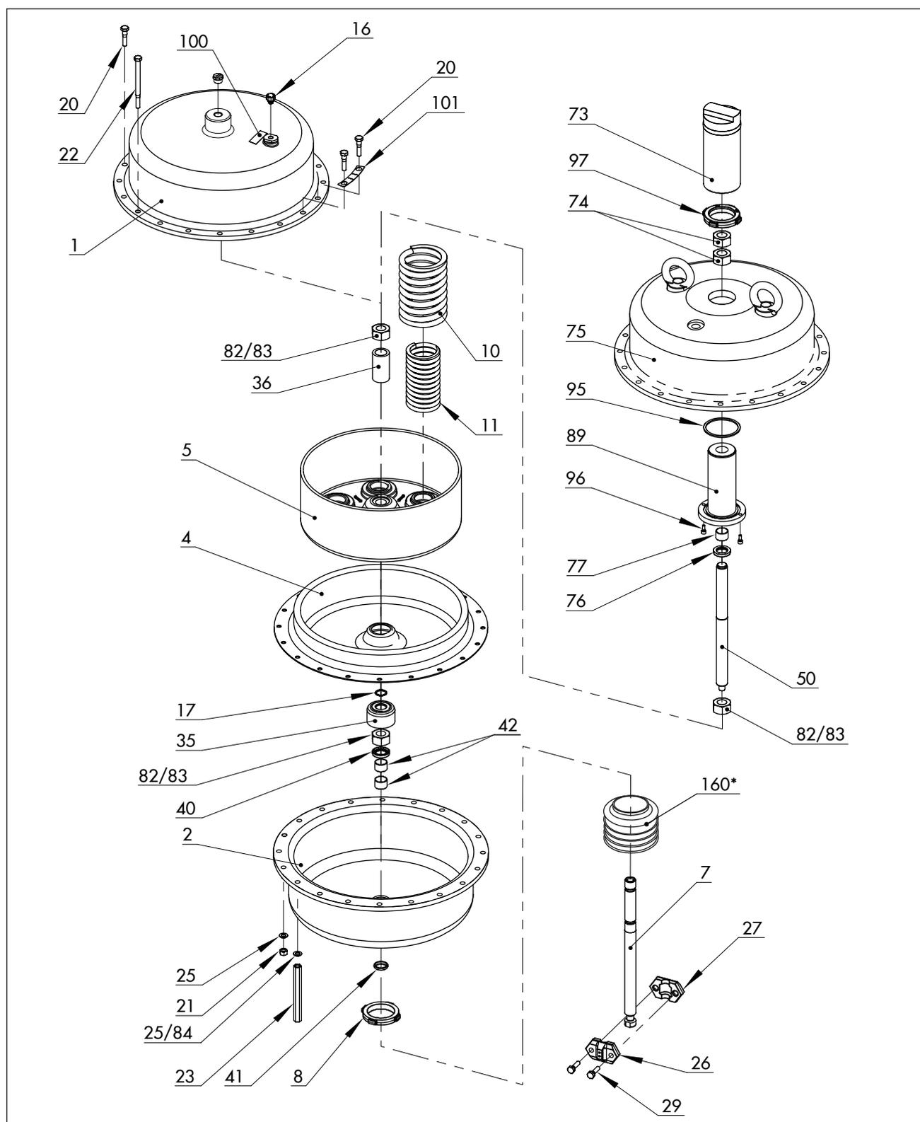
Рис. 18: Привод Тип 3271, 2800 см<sup>2</sup>
