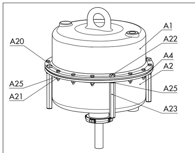
**Рис. 15:** Привод с зажимными винтами и зажимными гайками
